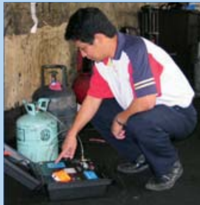
Gore: Prijenosni analizator rashladnih plinova u radu Gore desno: Uzorci boca za laboratorijsku analizu
